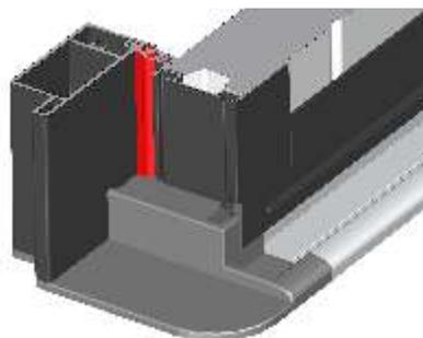
Joint d'étanchéité tubulaire EPDM côté ouverture
