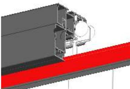
Joint d'étanchéité EPDM sur linteau
