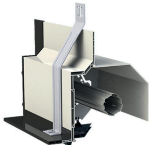
Le volet roulant demi-linteau est solidarisé avec la menuiserie et les deux se posent en une seule fois. Par contre, le coffre en lui-même est posé lors de la construction. Le volume pour les lames est moins important, ce qui permet de gagner en épaisseur d'isolation.
