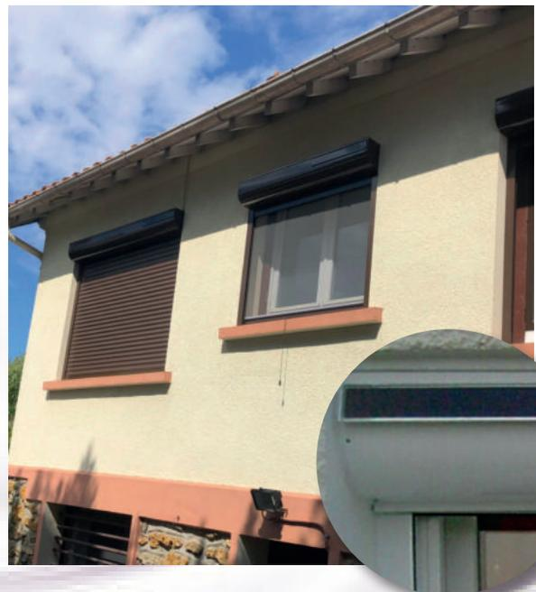
Pas de travaux, aucun raccordement secteur, autonomie, installation indépendante au réseau électrique et une autonomie de 45 jours composée d'un moteur RTS, d'une batterie et d'un panneau solaire.
