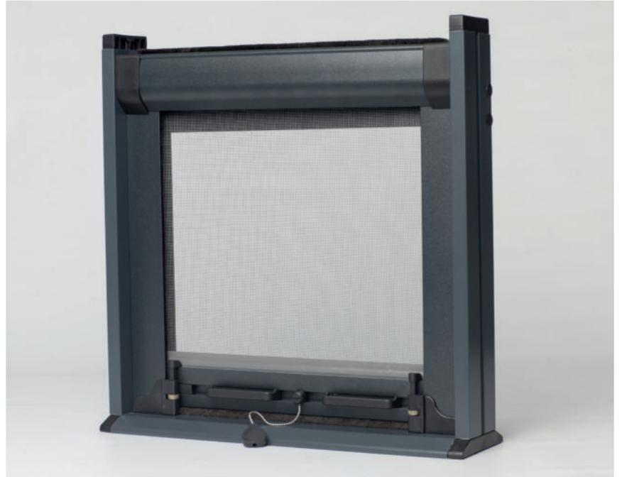
Moustiquaire enroulable verticale. Toile en fibre de verre M1 grise. Coffre aluminium extrudé design arrondi avec joint brosse supérieur intégré. Lame finale avec deux poignées et cordelette de tirage. Coulisse aluminium extrudé avec double joint brosse intégrée.
